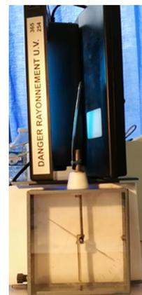
Photo 1 : Montage illustrant l'effet photoélectrique
